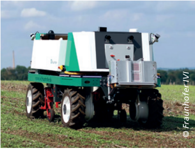
Feldroboter CERES mit Sensorbox
