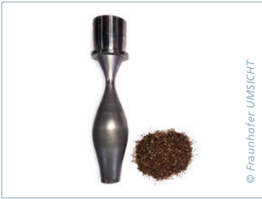
Ultraschallsonotrode und getrocknete Kaffeepulpe
